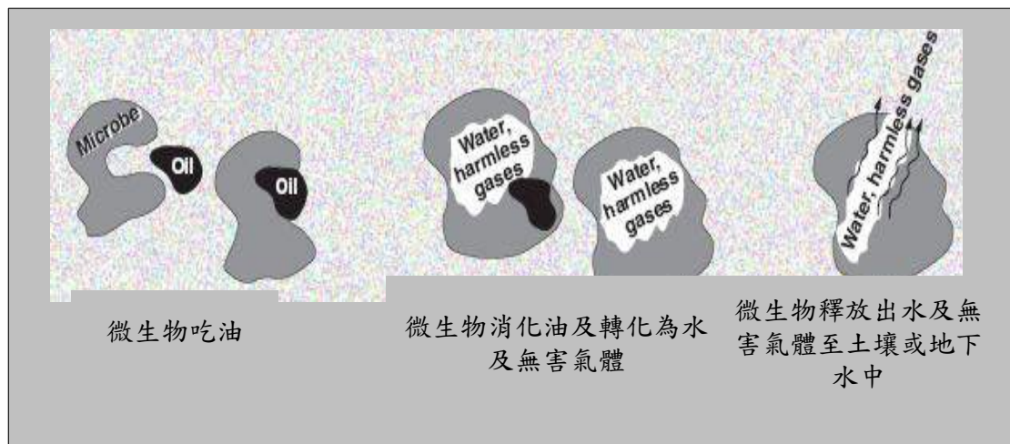
圖 3.1.1-1 微生物處理有機污染物之概念示意圖
