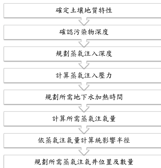
圖 4.2.1-1 蒸氣注入系統規劃設計流程圖
