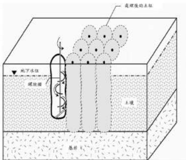
圖 5.2.4-2 利用螺旋鑽混合土壤
