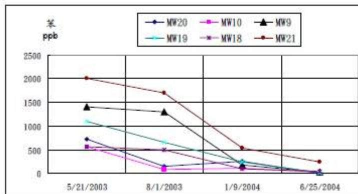
圖 11.2-5 監測井 MW9、MW10 及 MW18~MW21 之苯濃度變化圖
