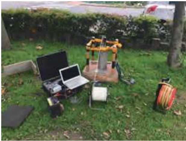
▲區域性監測井內部維護之井中攝影情形
