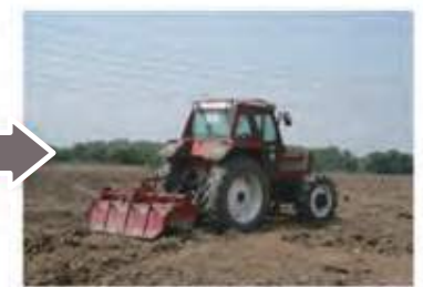
步驟 3: 完成高污染區土壤一至低污染區作業
